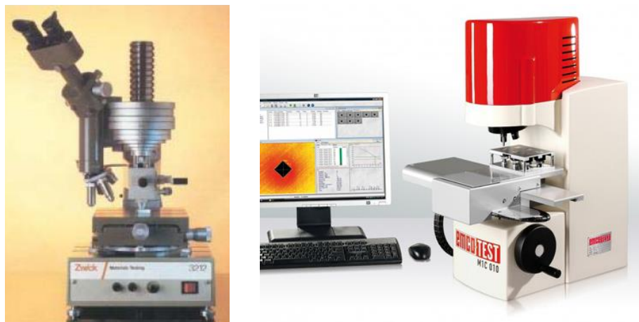
Slika 3.3 a) Analogni tester za Vickers, Brinell i Knoop sa dodatcima za mikro i makro opterećenja; b) digitalni tester sa malim opterećenjima za Vickers, Brinell i Knoop (dijapazon HV 0.1 – HV 30)
